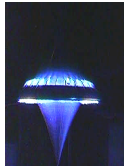
Modelo experimental con propulsión a láser ideado por el Prof. Myrabo.
