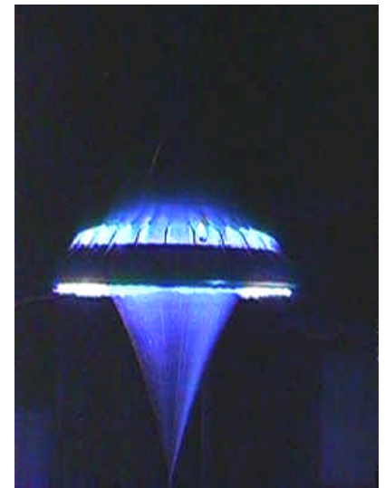
El "Lightcraft" se elevaría en una serie de pulsos de aire caliente producidos por un láser de alta energía. Aquí el experimento con un modelo a escala.
